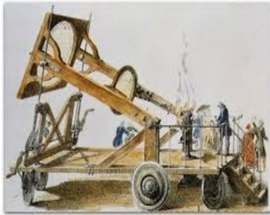
Figura 5. Lupa xigante da Academia usada por Lavoisier para queimar \text{C}_d . En “El cuaderno del químico escéptico”, https://wolframio1783.blogspot.com/2014/11/un-experimento-no-apto-para-todos-los.html .
